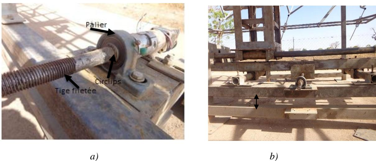
Figure 21 : a) Système de blocage de la tige filetée avec le palier à travers un circlips.
