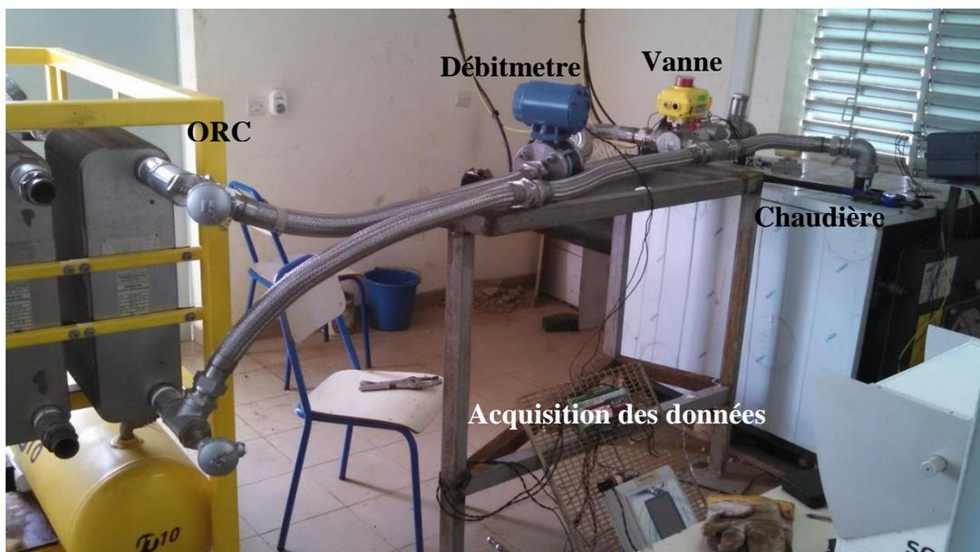
Figure 17 : Schéma du banc de test après installation.
