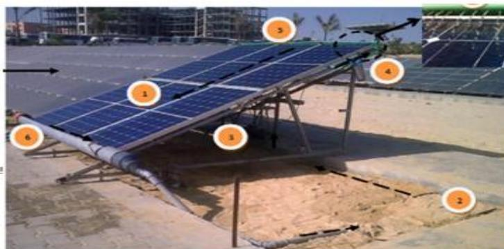
Figure 7 : Plateforme de nettoyage des modules PV à l'eau et au détergent[7]
