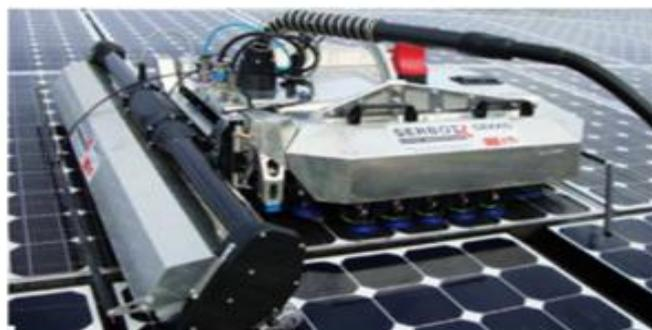
Figure 4 : Appareil pour le nettoyage mécanique des modules PV[9]
