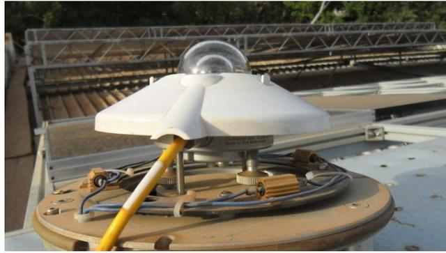
Figure 9 : Pyranomètre de type KIPP & ZONEN CM 11/14
