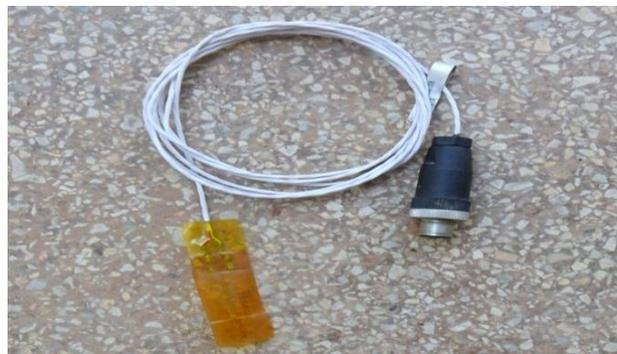
Figure 10 : Sonde de température Pt100
