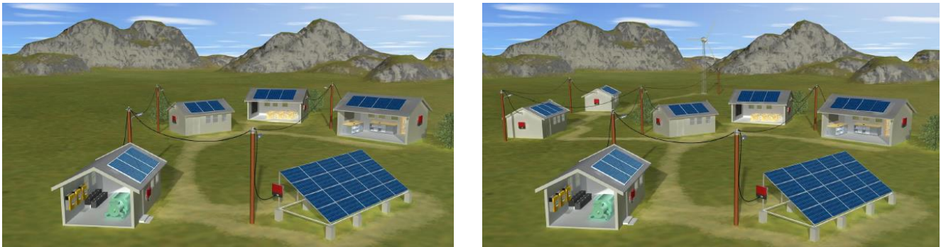
Figure 5: Configuration PV/Diesel parallèle avec plusieurs onduleurs [2]
