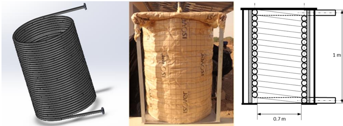
Figure 11: Description du récepteur solaire de la centrale à tour CSP4AFRICA
