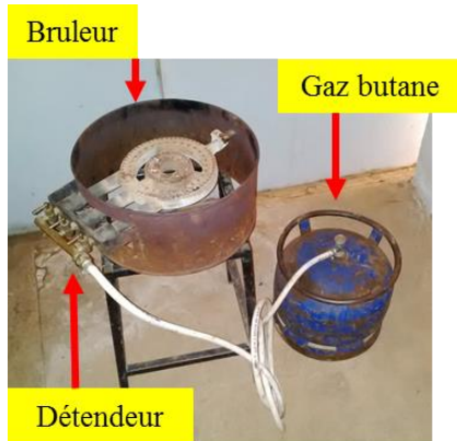
Figure 16: Le poste de combustion
