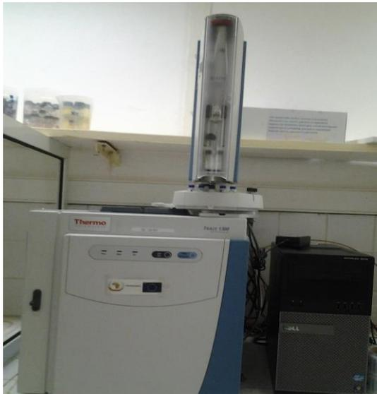
**Figure 10:** Chromatographe en phase gazeuse
