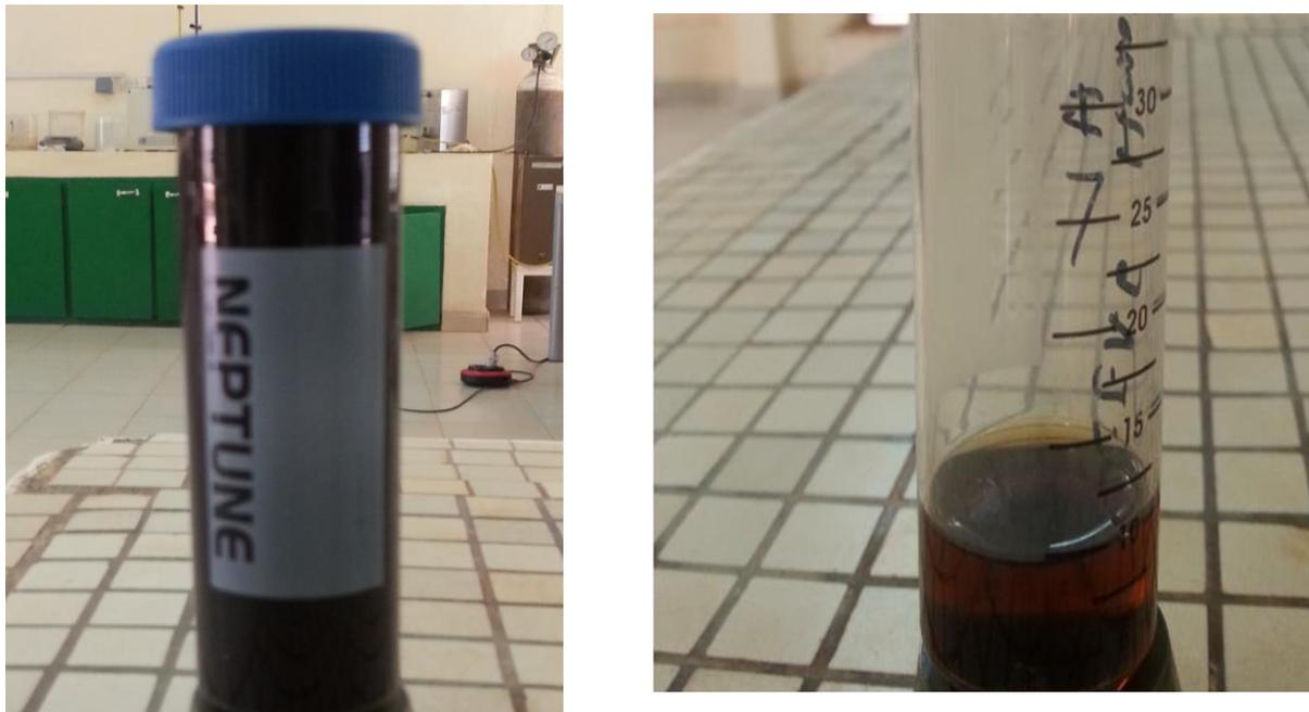
**Figure 17:** Ester Ethyle d'Acide Gras (biodiesel synthétisé)
