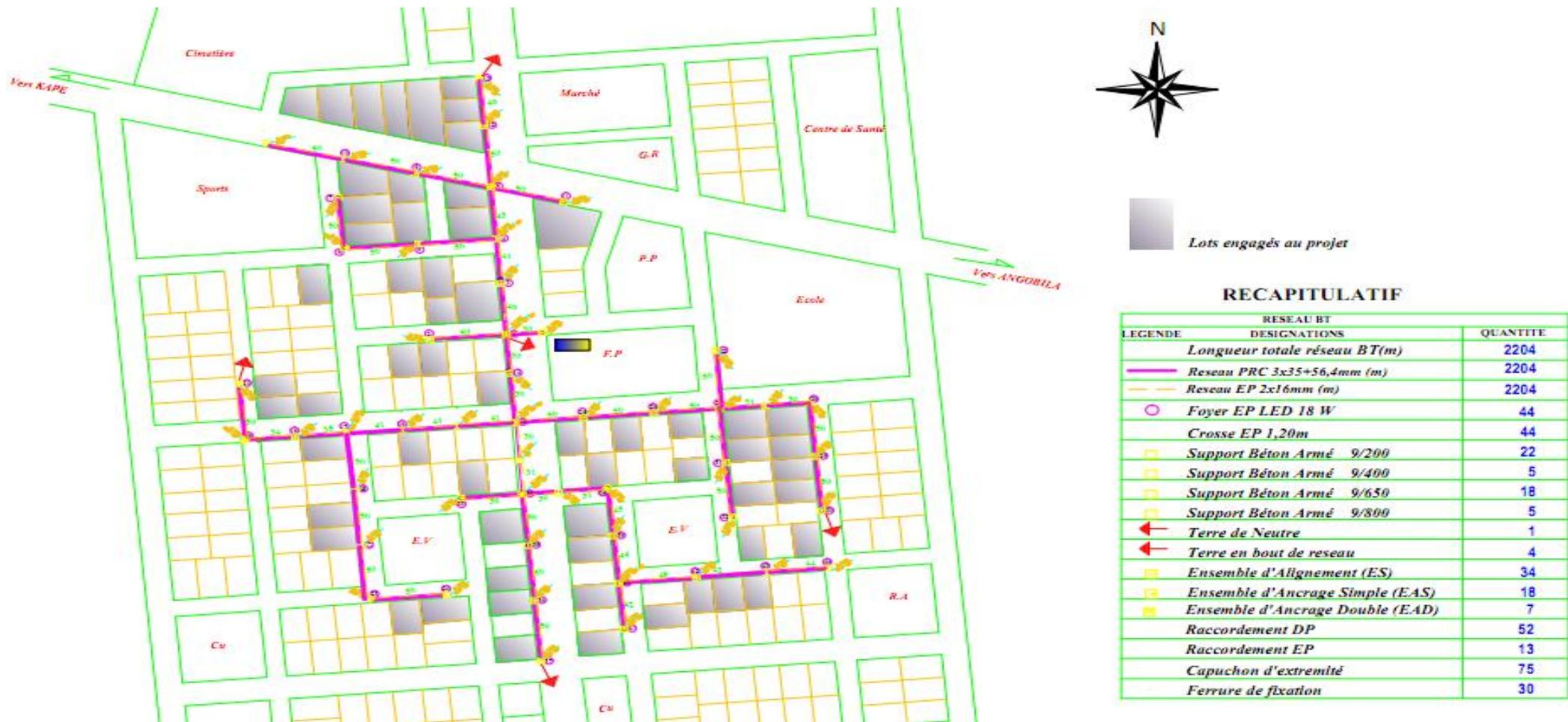
Figure 30 : Tracé de ligne du réseau basse tension et éclairage public de Kromambira
