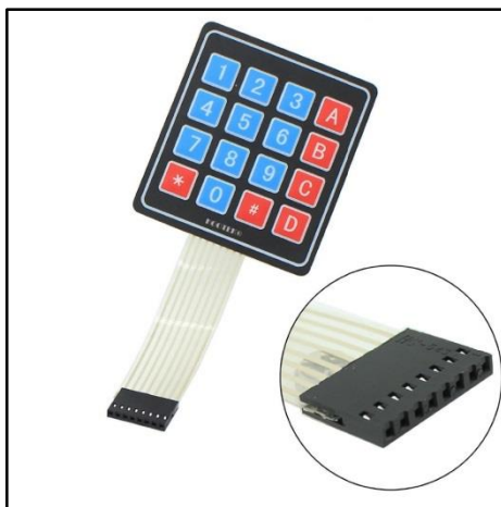
Figure 3 : Clavier matriciel 16 touches
