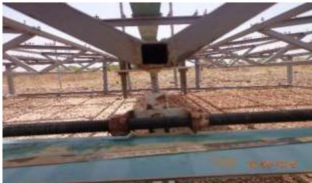
**Figure 23: Fixation du chariot sur la tige filetée**
