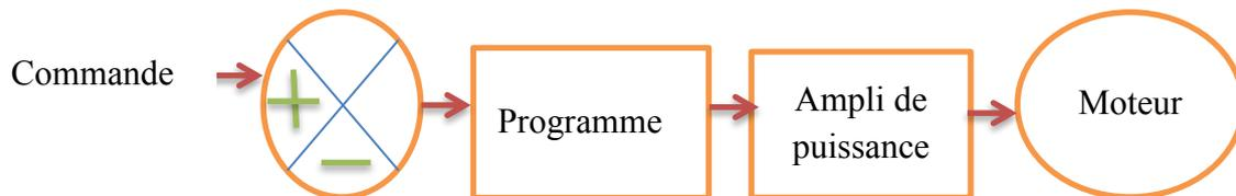
**Figure 25: Fonctionnement en boucle ouverte**
