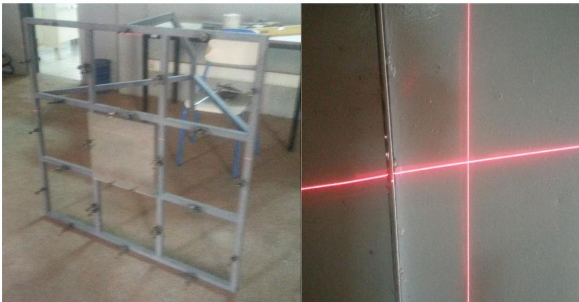
Figure 41 : Ajustement du miroir central par rapport à la normal au réflecteur
