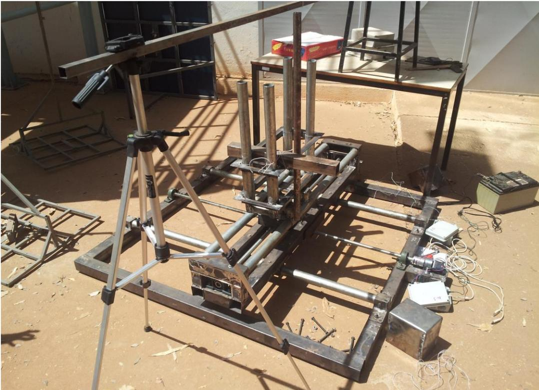
*Figure 47 : Test à vide de la motorisation V2*
