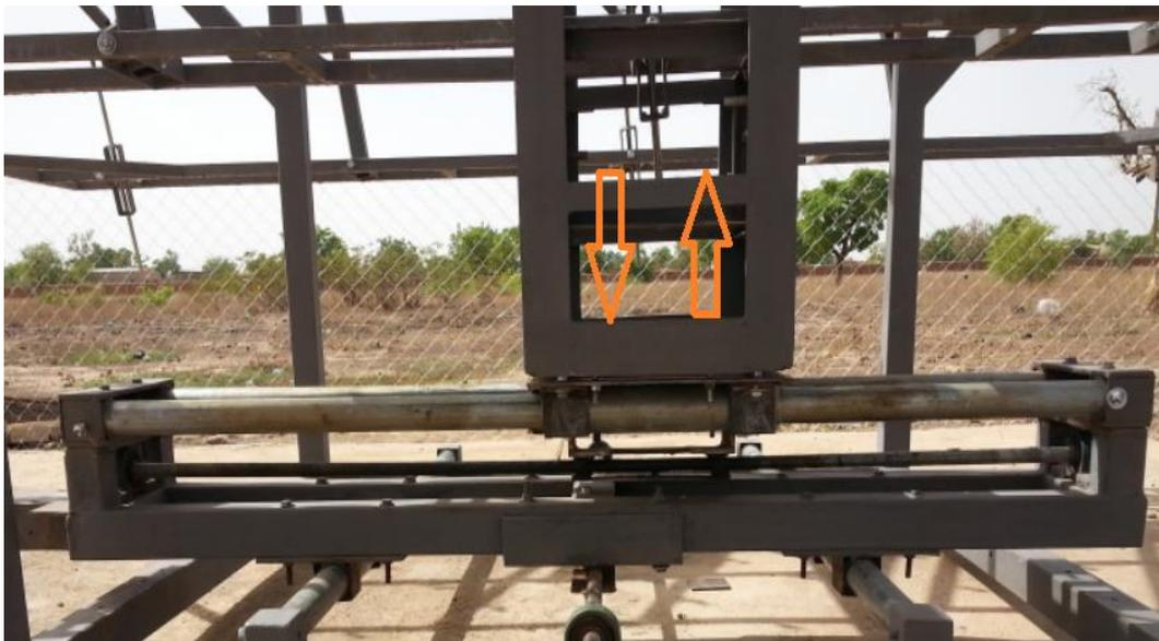
Figure 35 : Schéma illustrant les mouvements haut et bas de la grille
