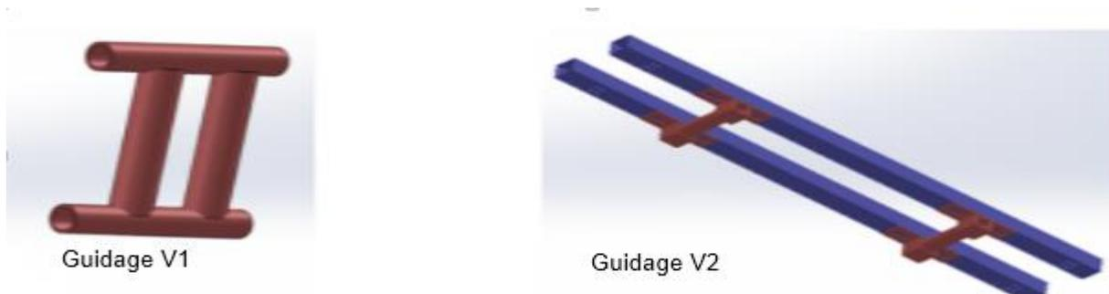
Figure 18 : Modification de la longueur de guidage
