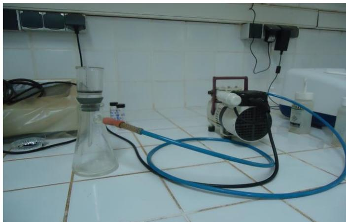
Figure 7: Dispositif de filtration
