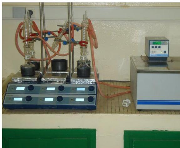
Figure 6:dispositif de réaction de transestérification
