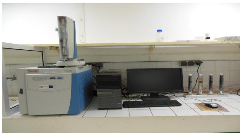
**Figure 12 : Chromatographe en phase gazeuse couplé à l'ordinateur d'acquisition de données**
