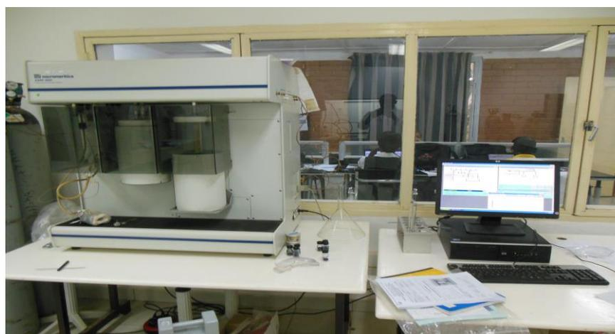
**Figure 13: analyseur de surface et de porosité couplé à l'ordinateur d'acquisition de données**
