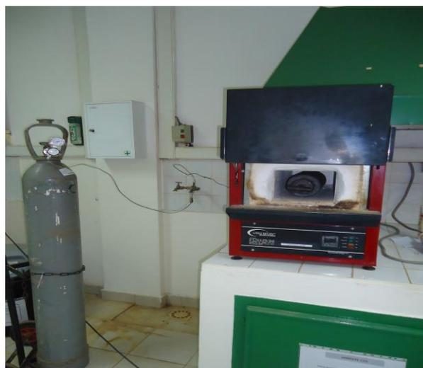
Figure 5: De gauche à droite bouteille d'azote (ou CO<sub>2</sub>), four à moufle avec le tube métallique à l'intérieur
