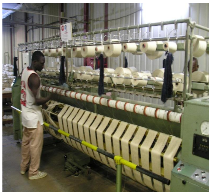
Annexe 8 : Opération du dévidage
