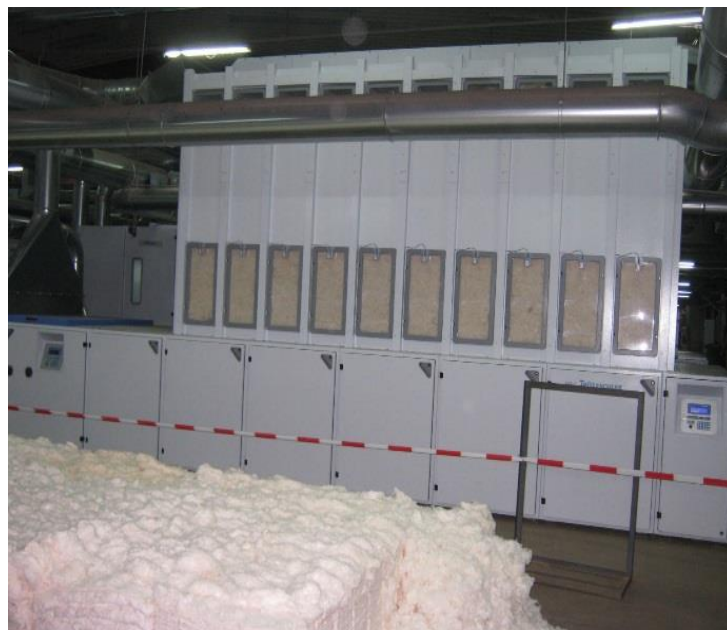
Annexe 2 : Mélangeuse lors du battage
