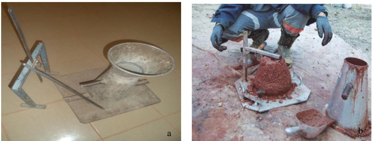
Figure 12: Cône d'Abrams et mesure de l'affaissement
