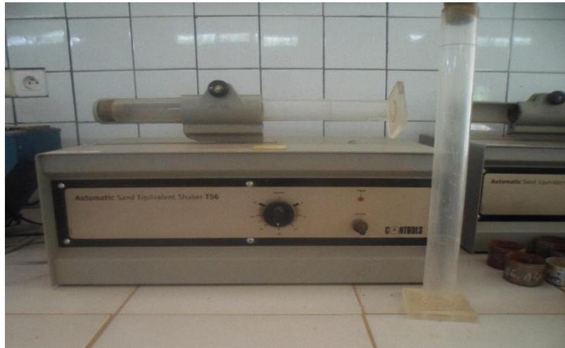
**Figure 3:** Agitateur d'équivalent de sable et tube à essai
