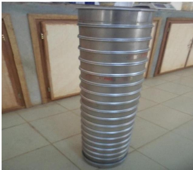
Figure 2: série de tamis utilisés pour l'analyse granulométrique
