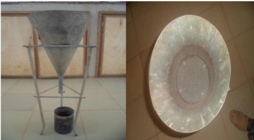
Figure 5: Cône normalisé pour mesure de densité apparente
