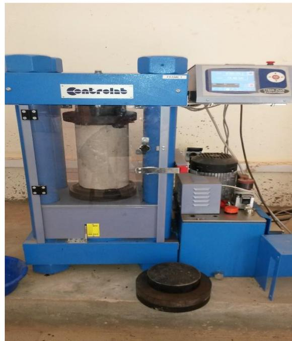
**Figure 16:** Presse à béton capacité 2000KN
