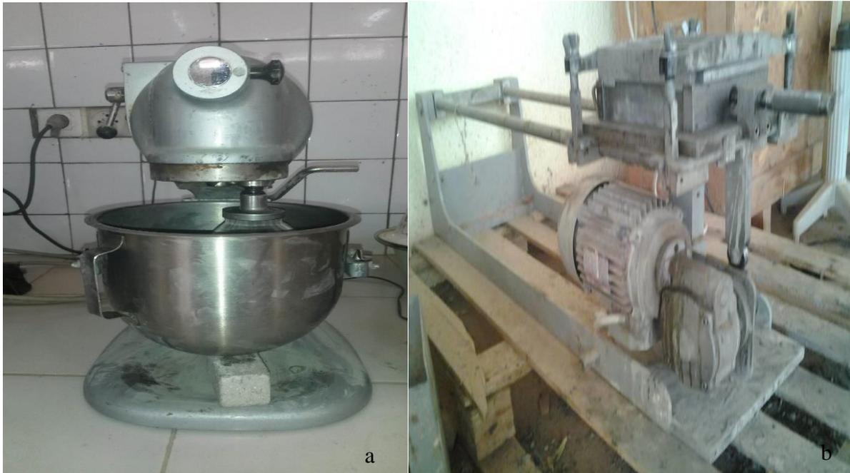
Figure 11: Malaxeur électrique et appareil à choc surmonté du moule 4\*4\*16
