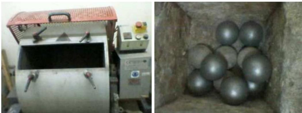
**Figure 4:** Machine Los Angeles et boules d’essai
