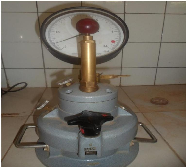
**Figure 6: Pycnomètre à air**
