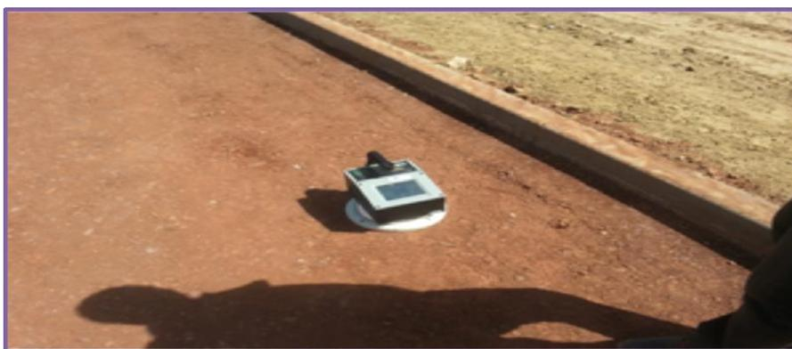
Figure 12 : appareil de mesure de la compacité (gamma densimètre troxler 3440)
