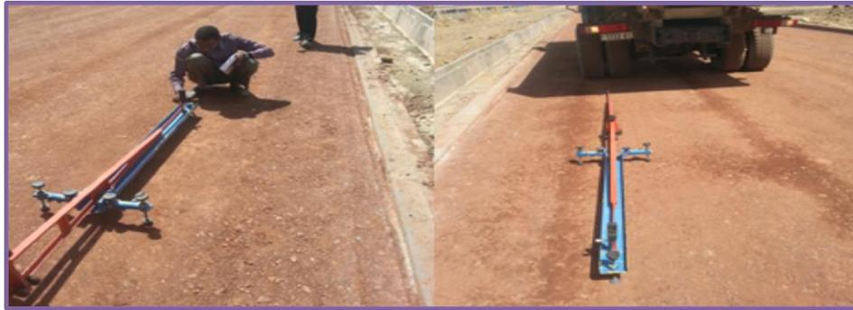
Figure 13 : poutre de Benkelman
