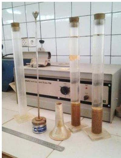
Figure 15: Matériels pour l'essai d'équivalent sable
