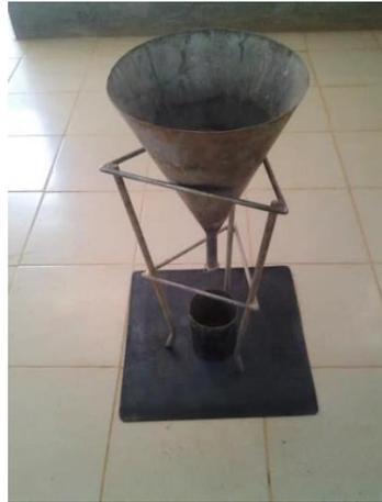
Figure 13: Cône normalisé pour la masse volumique apparente
