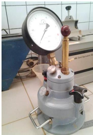
Figure 14: Pycnomètre à air
