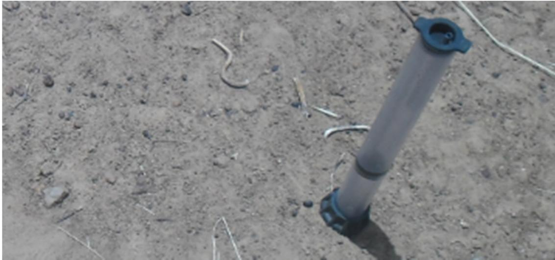
Figure 9: Tensio-infiltromètre à mini-disque fabriqué par Decagon Devices
