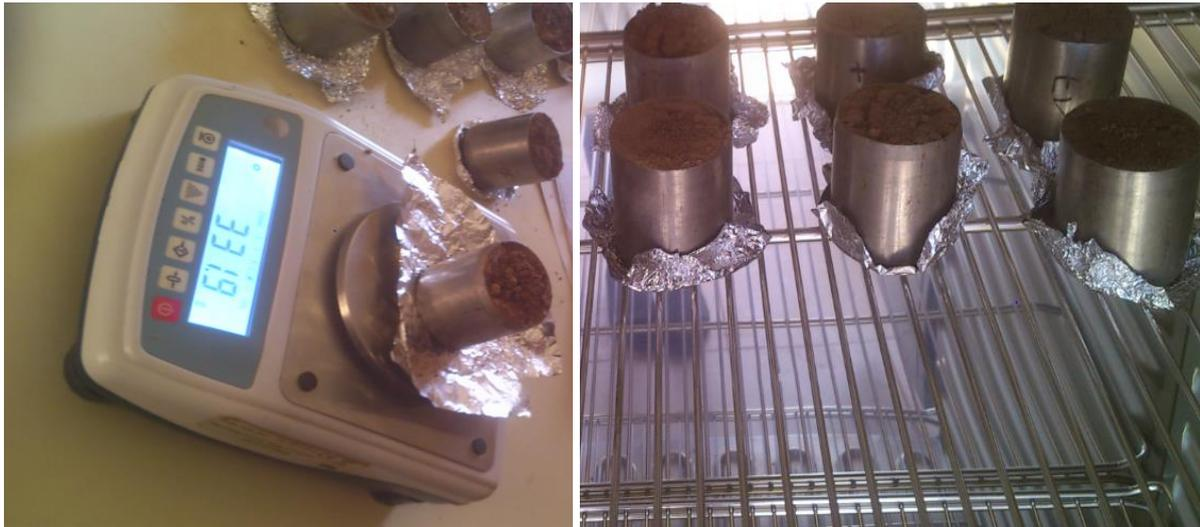
*Figure 8 : Balance et échantillon mise à l'étuve*
