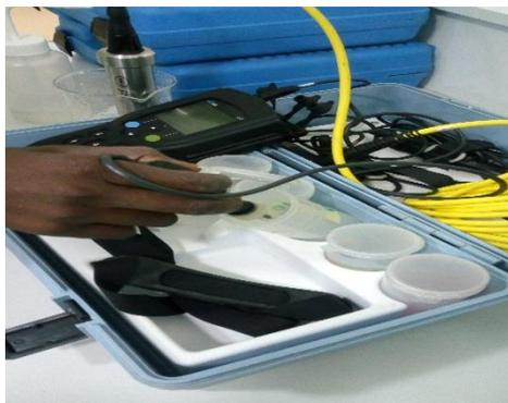
Figure 6:Processus d'étalonnage du HQ 40d
