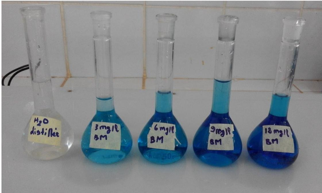
**Figure 9:** Solution étalon pour l'établissement de la courbe.
