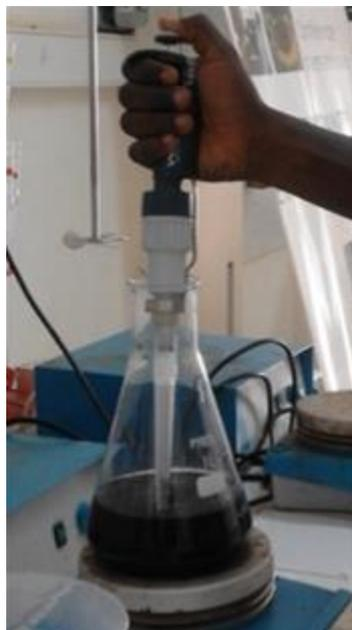
**Figure 7:** Test de décoloration : prise de solution de BM
