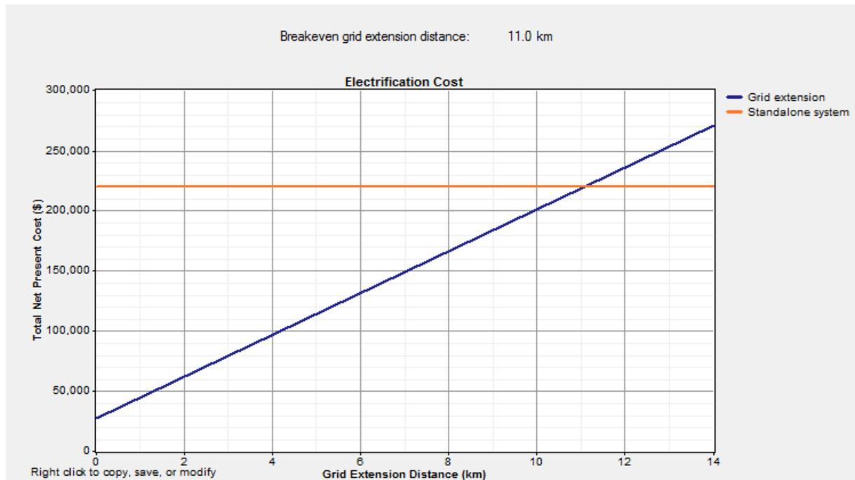
Figure 27: Comparaison du coût par km entre le réseau et le système hybride
