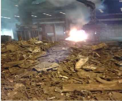
Figure 12: Processus de chargement du four
