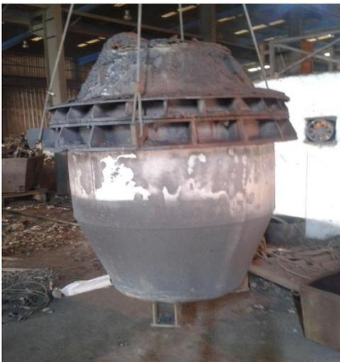
Figure 7: Vessel pour la décarburation
