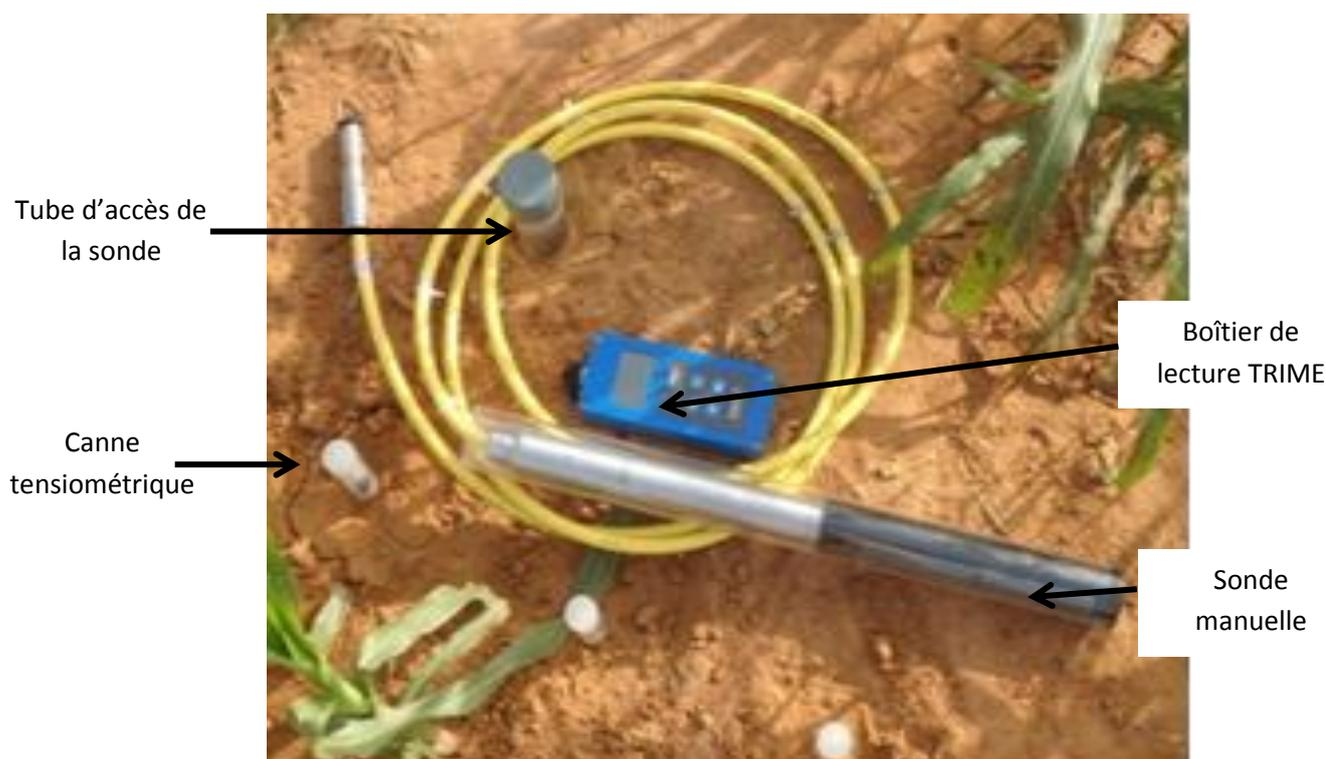
**Photo 11:** Sonde, boîtier TRIME, tube d'accès et cannes tensiométriques
