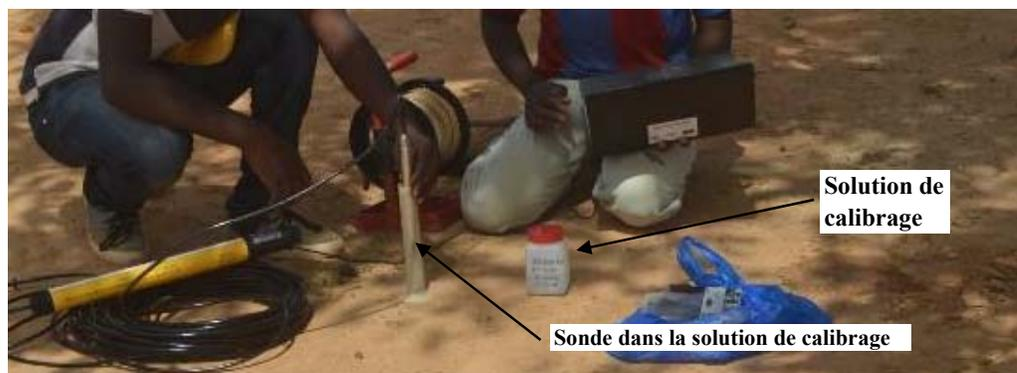
*Figure 23: Calibration des sondes*
