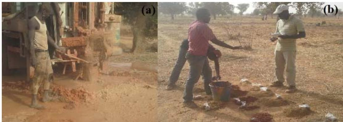
Figure 16: Prélèvement de cutting(a) et identification des formations géologiques(b)
