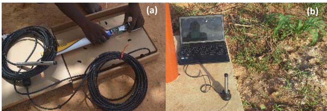
Figure 11: Sonde Ecolog 800 (à gauche) et sonde Solinst (droite)
