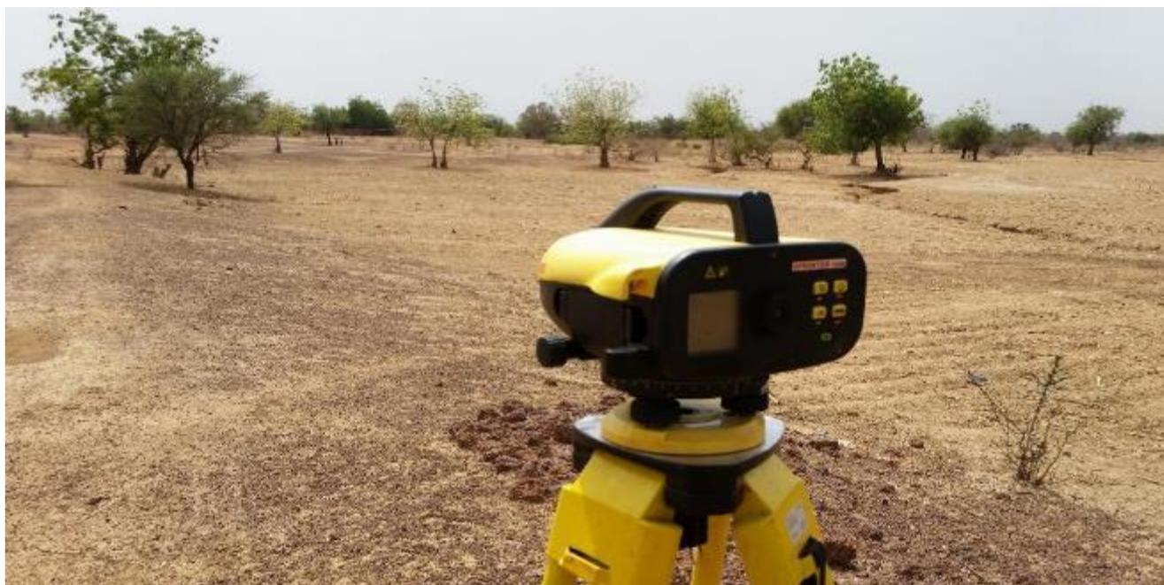
Figure 5: Niveau LEICA SPRINTER 150M
