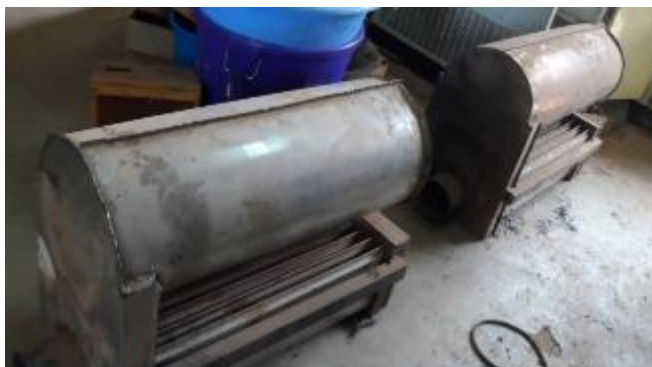
Fig. 8 Echangeur de chaleur du générateur : copie CEA BF et version originale
