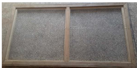
Fig. 4. Image d'une claie en bois et grillage en inox (source : CEAS Burkina)
