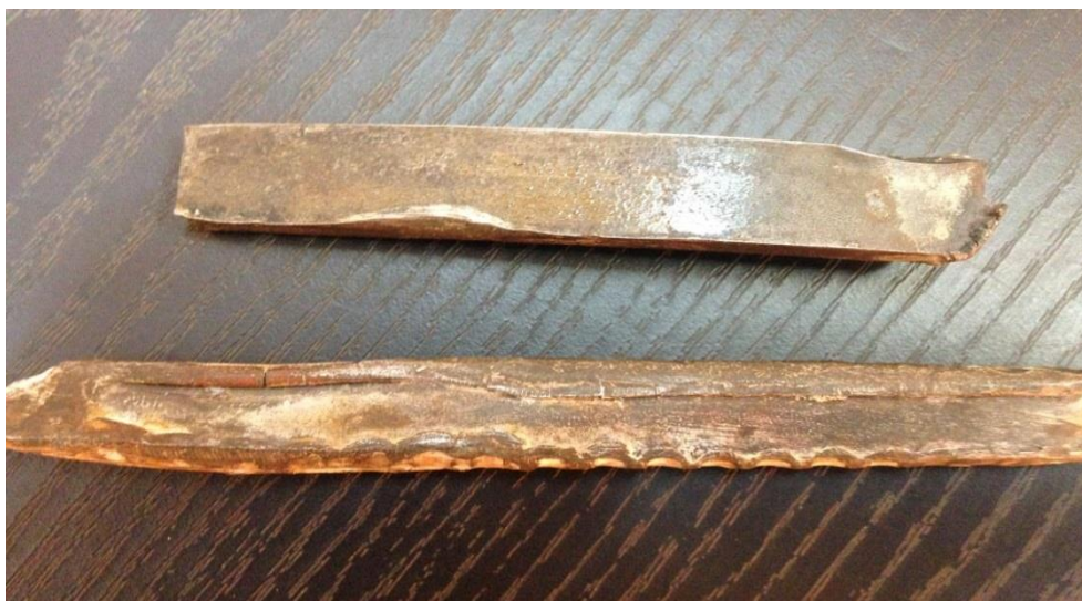
Figure 16 : Cales ou Dents des tôles magnétiques du stator
