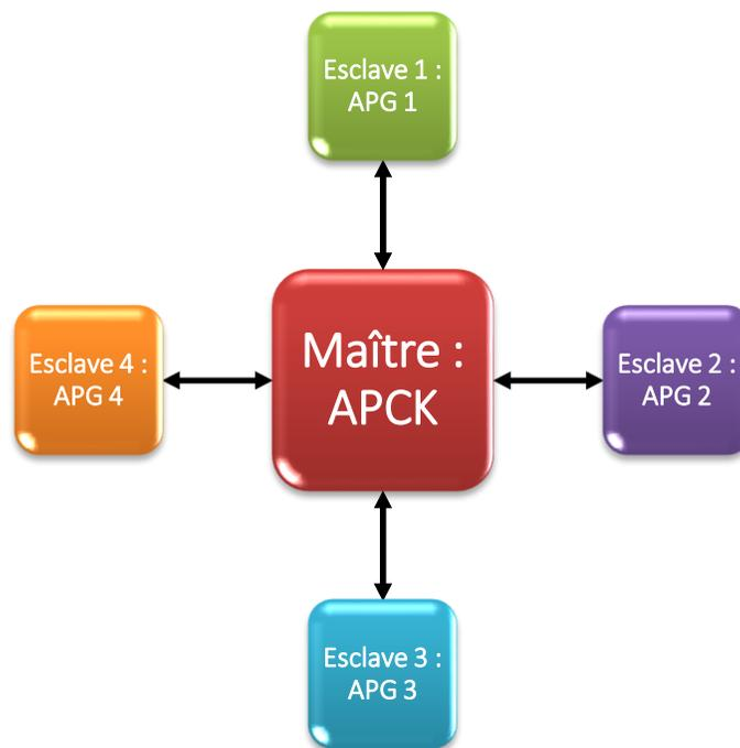
*Figure 11 : Réseau d'automates de la centrale*
