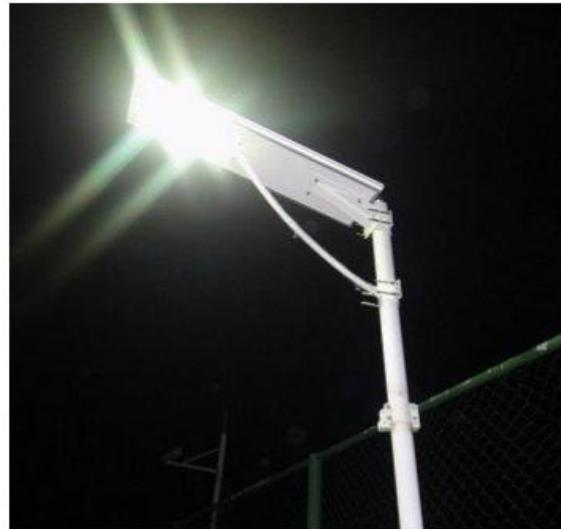
**Tête de Lampadaire Solaire Puissante Tout Intégré ZS-A701D-40**, panneau solaire 60 W, led bridgelux 40W, 4400 lumens, batterie lithium 307,20WH, éclairage solaire permanent mi puissance + détecteur de mouvement pleine puissance, approprié pour l'éclairage solaire autonome et puissant de voies, parks, rues, ou en remplacement de lampadaires existants. Option **Version Hybride**.
