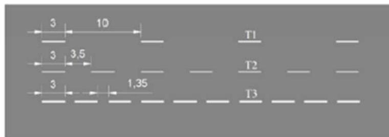
Figure 8: modulation des marquage au sol
