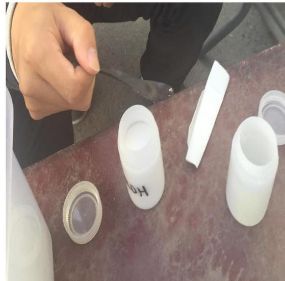
Figure 5 : Ajout d'une dose de NaOH dans un échantillon de 100 ml
