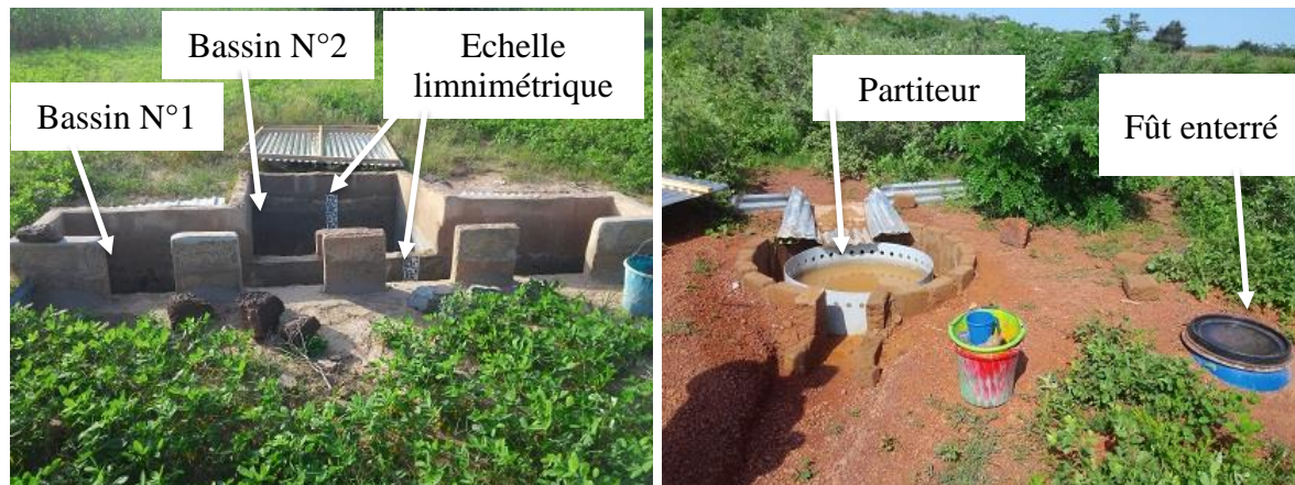
Figure 10: dispositifs de mesure du ruissellement
