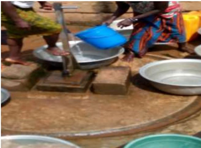
Figure 3 : Hydropompe Vergnet à pédale
