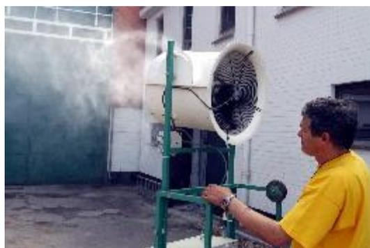
***Figure 3 : Atomiseur centrifuge***
