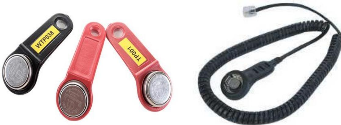
Figure 18 : Thermopuces et HygroPuces sur porte-clés fixe avec un lecteur thermopuce [30]
