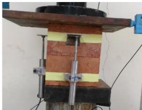
**Figure 2-9 : Dispositif d'essai de compression sur les échantillons de BTC**
