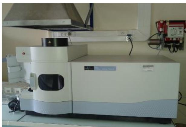
**Figure 2-1 : ICP-OES de type Perkin Elmer TM optima 7000 DV**
