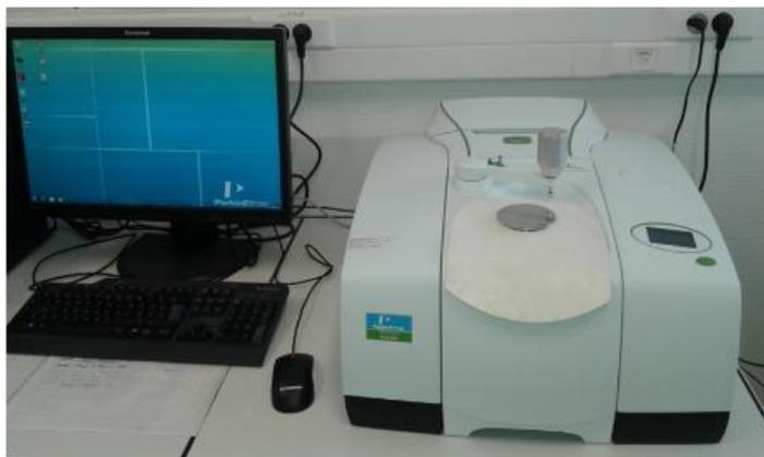
**Figure 2-5 : Spectroscopie infrarouge (type Perkin Elmer L125000P Frontier)**
