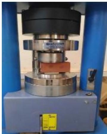
**Figure 2-8 : Dispositif d'essai de compression des liants géopolymères**
