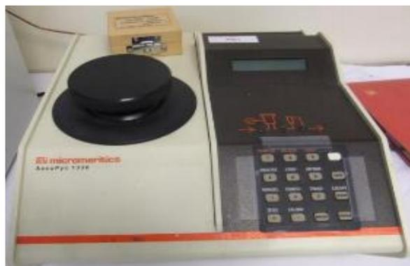
**Figure 2-2 : Pycnomètre à hélium pour la mesure de masse volumique absolue des échantillons**
