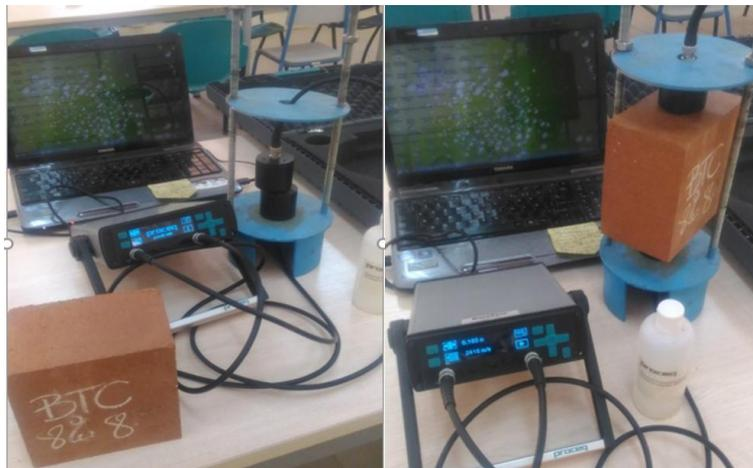
**Figure 2-11 : Dispositif d'essai pour la détermination du module de Young sur les échantillons de BTC**
