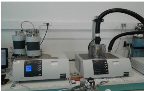
Figure 2-3 : ATG Netzsch QMS 403C et DSC Netzsch STA 449F3
