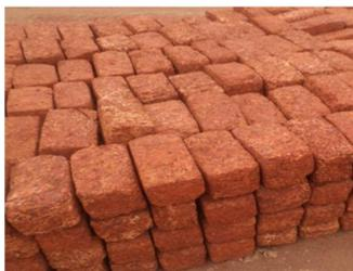
Au Tchad les latérites encore appelées blocs de latérite taillés (BLT) sont fréquents dans la région montagneuse plus précisément au nord et centre. Ce sont des sols rouges riches en oxydes de fer et d'aluminium on les trouve en faible profondeur. La granulométrie varie des particules fines, au gravier, jusqu'au
