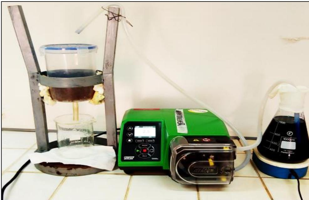
**Figure 15 :** Réacteur à lit fixe mis en place
