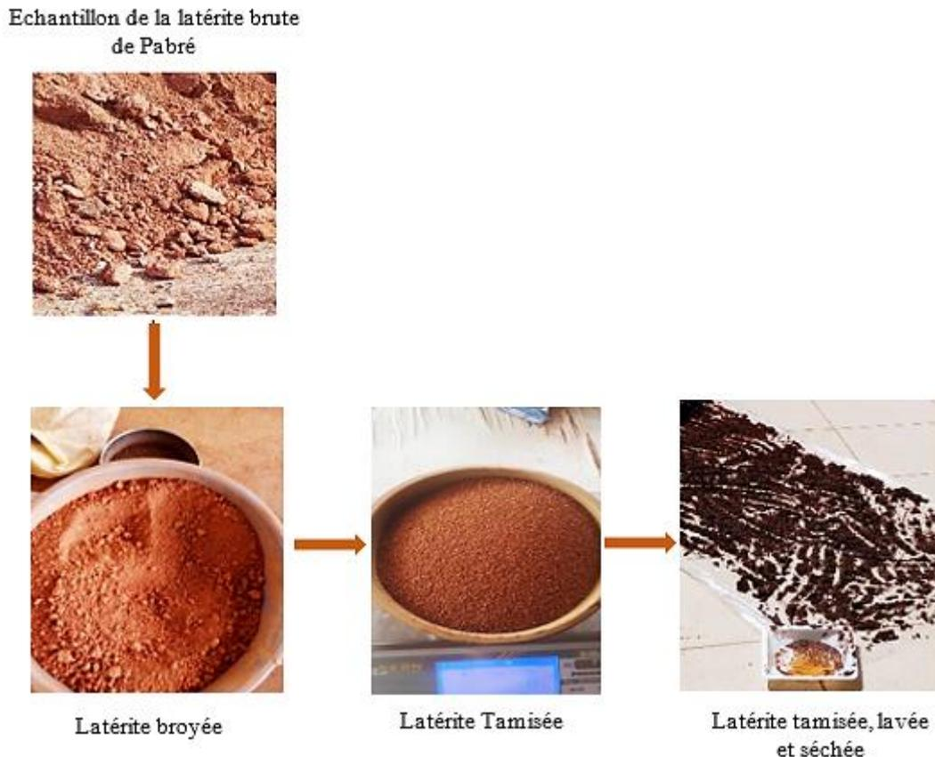
Figure 4 : Processus de préparation des grains de latérite brute
