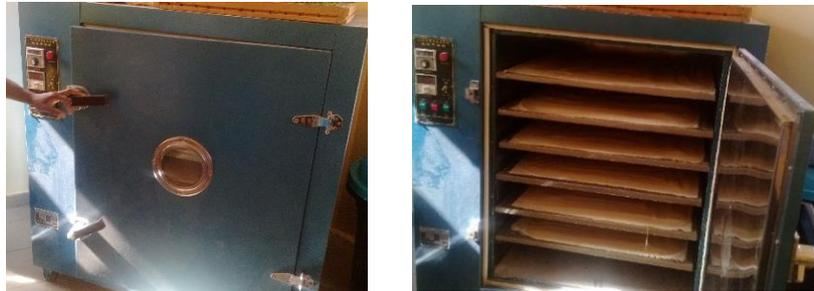
Figure 5 : Séchoir électrique de puissance 9 kW
