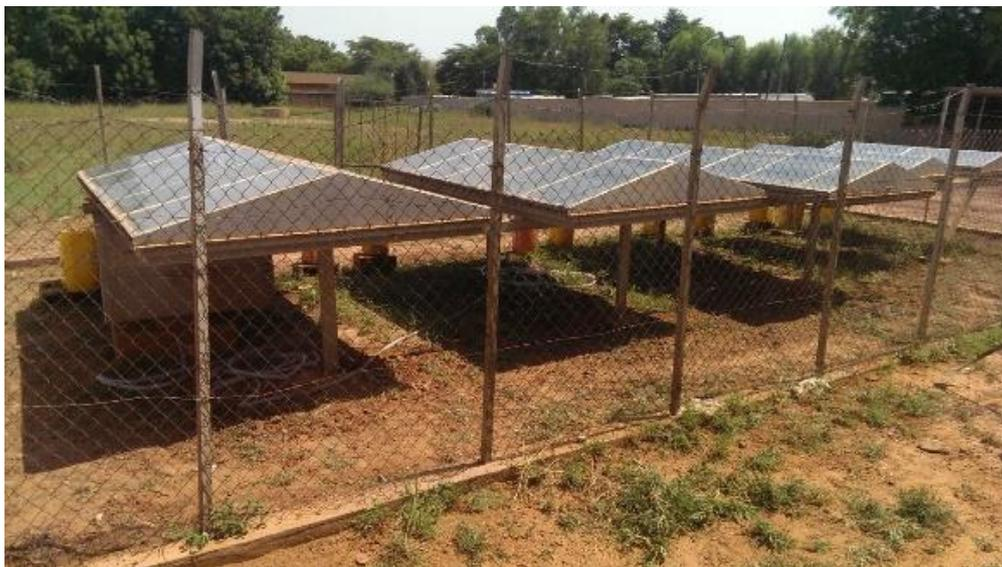
Figure 35 : Distillateurs fabriqués au CNES
