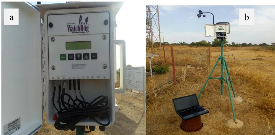
**Photos 5: a** : Station météo *WatchDog* – **b** : Matériels d'extraction des données climatiques
