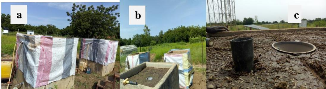
**Photos 6:** a :Lysimètres raccordés par les tuyaux – b :Lysimètres recouverts par les sacs - c :Mise en place de l'entonnoir et le tube PVC dans les lysimètres
