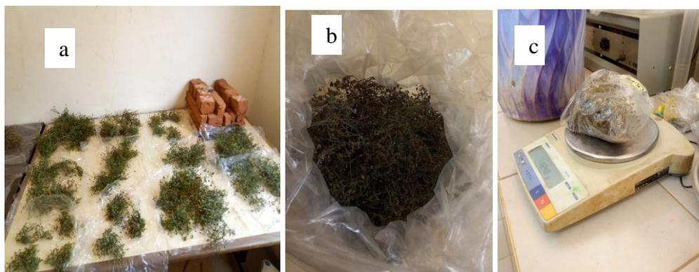
Photos 8 : a : Biomasse humide b : Biomasse sèche c : Appareil de mesure du poids de la biomasse
