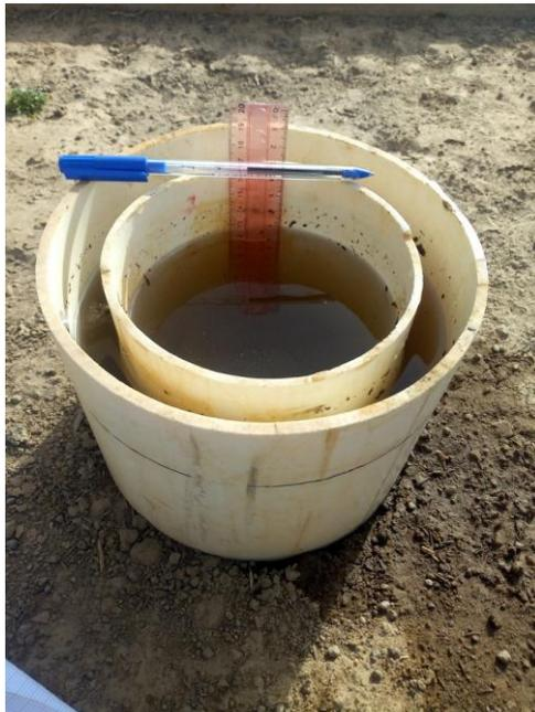
**Photo 4:** Matériels de mesures d'infiltrations (double anneau de Muntz)
