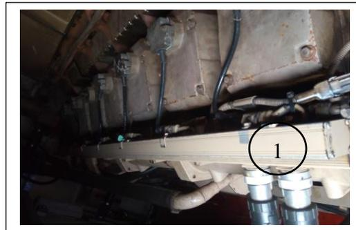
**Figure 16: Image du câble de communication principal (1)**
