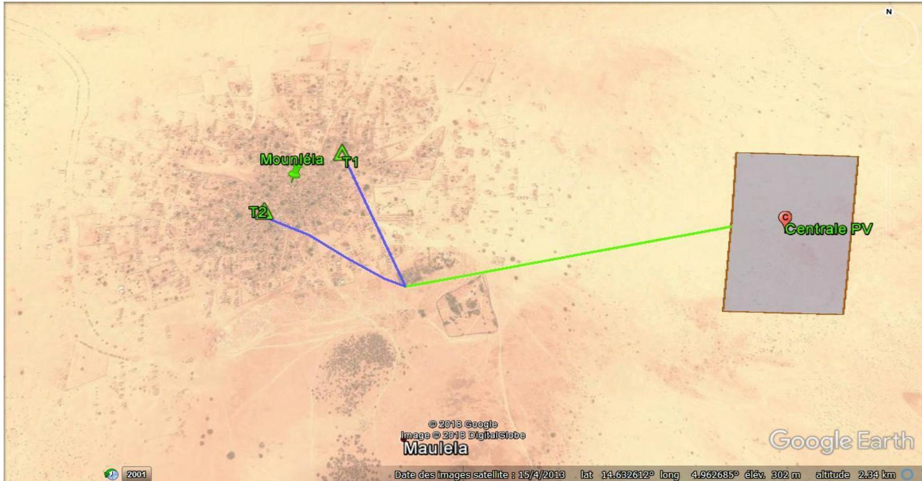
Figure 14 : Tracé des lignes HTA principale et secondaire
