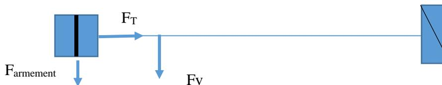
Figure 17: Différentes forces appliquées sur un support d'arrêt
