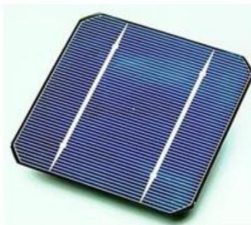
Figure 9: cellule en silicium monocristallin
