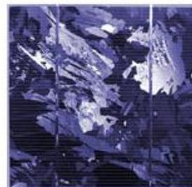
Figure 8: cellule en silicium polycristallin
