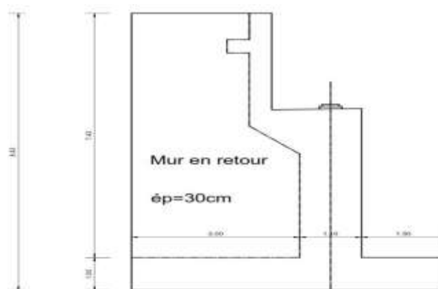
Figure 36: Représentation géométrique Mur en retour du pont
