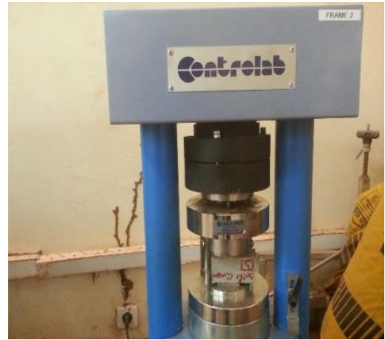
Photo 3 : Essai de compression des Mortiers
