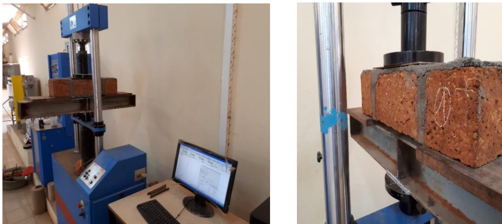
Photo 6 : Essai cisaillement sur Triplette
