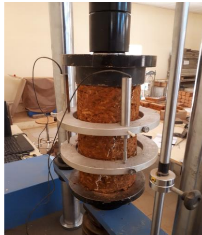
Photo 1 : Essai de compression BLT (Module de Young)
