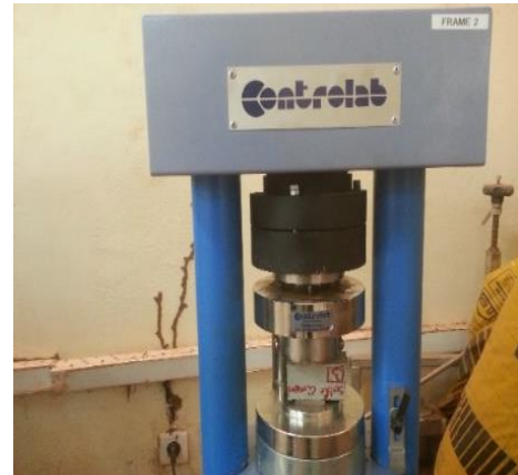
Photo 2 : Essai de compression Mortier
