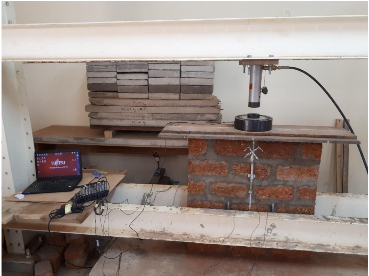
Photo 11 : Essai de compression de Muret sous chargement vertical (BLT)
