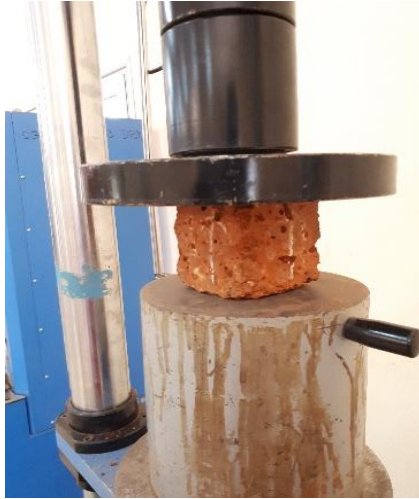
Photo 2 : Essai de Compression des BLT
