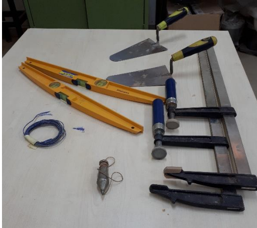
Photo 7 : Matérielle de confection et d'essai des murets
