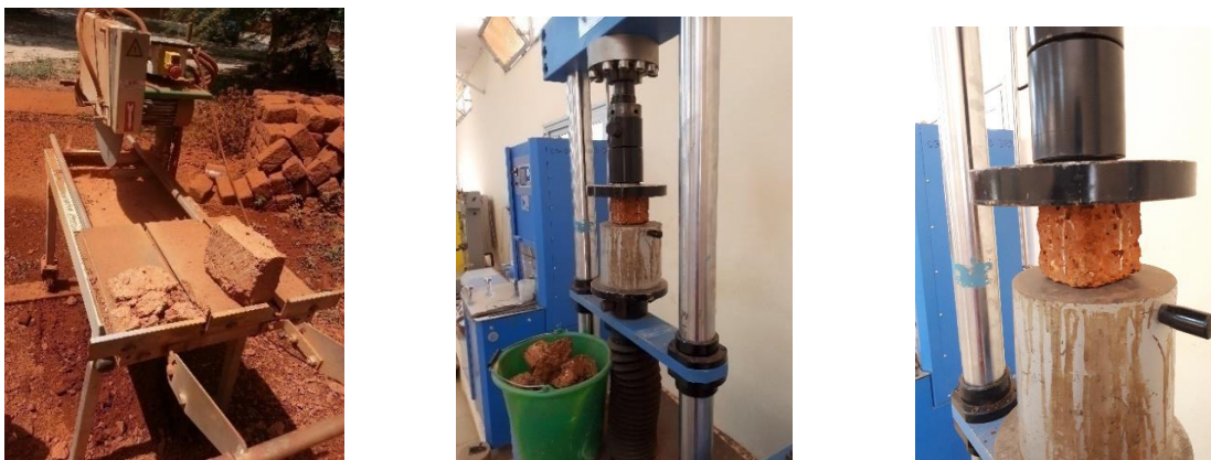
Photo 1 : Essai de compression BLT
