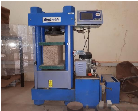
Photo 4 : Essai de compression des Parpaings
