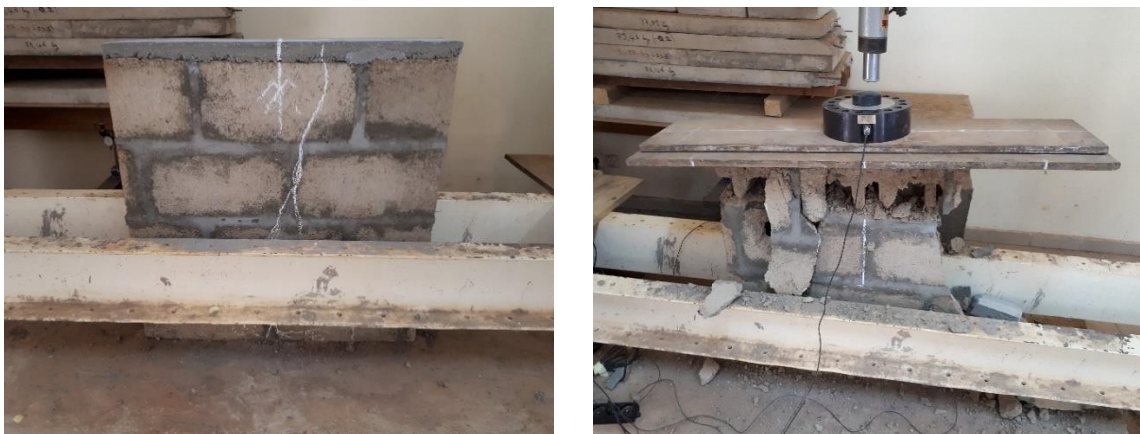
Photo 13: Fissuration et rupture du Muret en Parpaing sous chargement vertical
