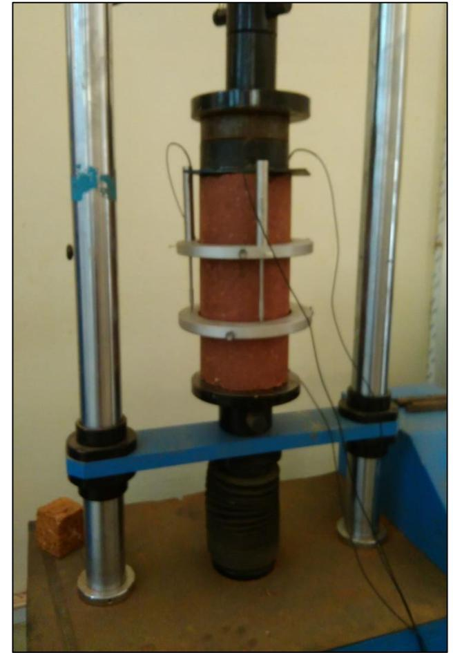
Image 12: Essai de compression uniaxiale
