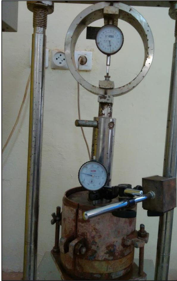
Image 11: Poinçonnement pour l'essai de CBR
