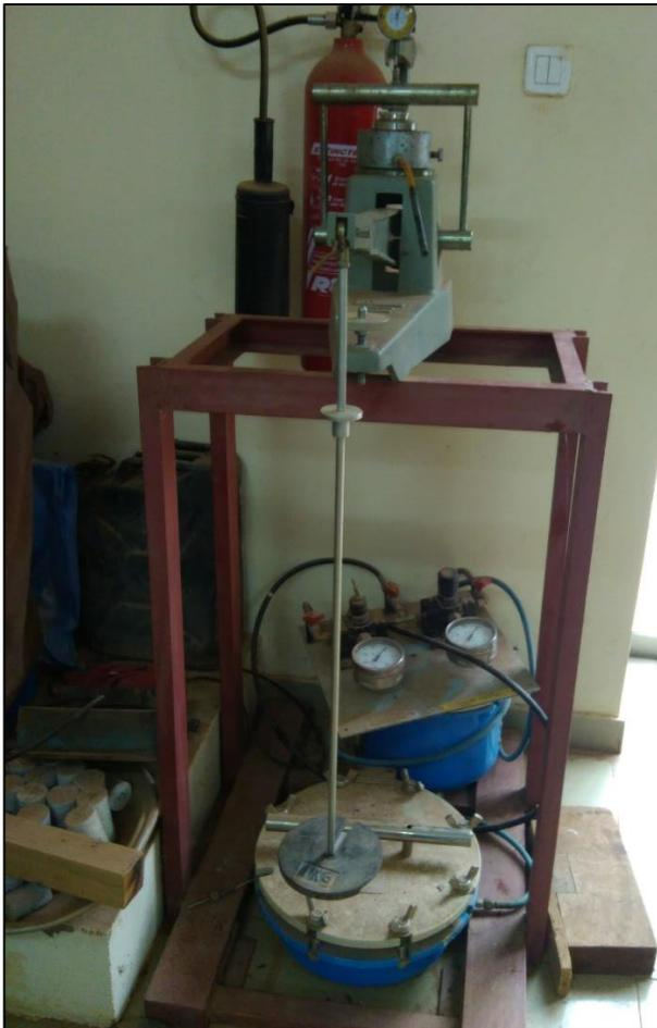
Image 10: Essai Œdométrique
