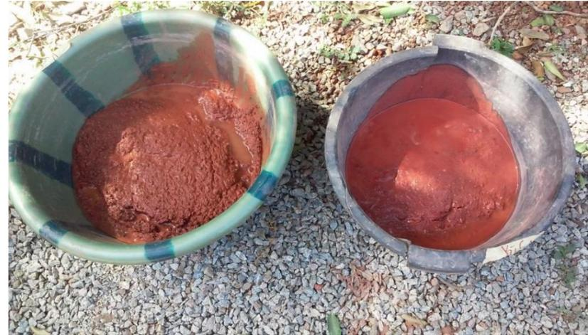
Image 5: Matériau lavé pour analyse granulométrique et limites
