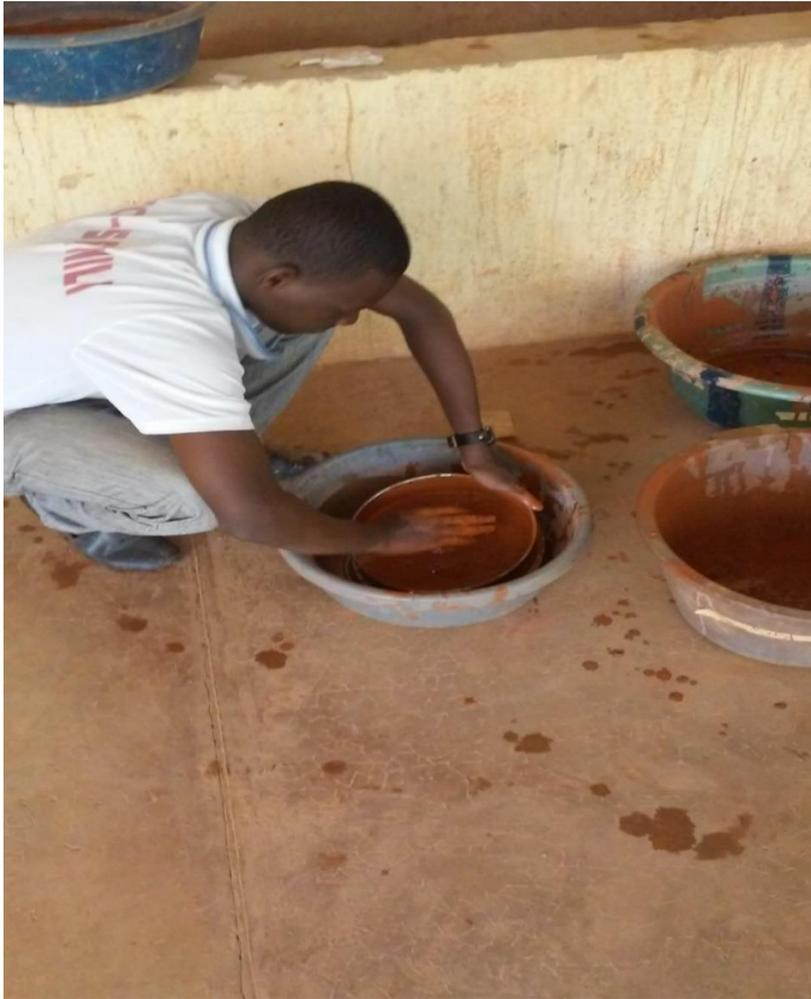
Image 4: Lavage du matériau pour essai géotechnique
