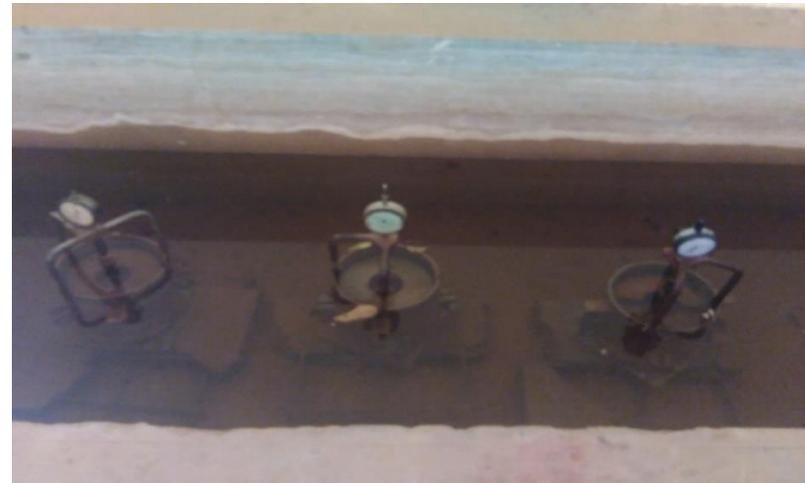
Image 6: Eprouvette en immersion pour essai de gonflement
