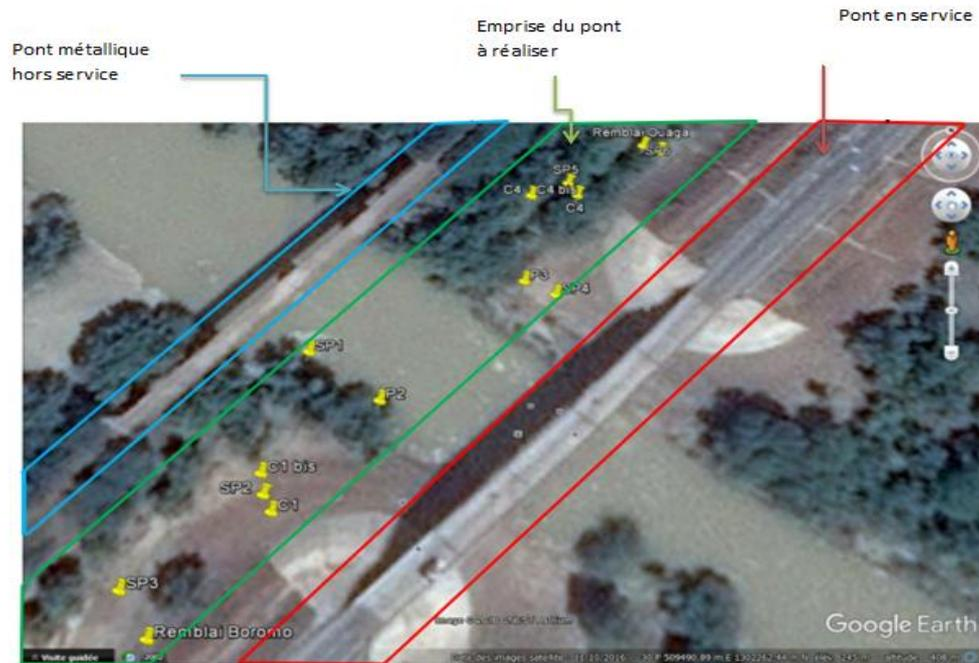
**Figure 2:** Vue Google earth du site avec les ouvrages existants, l'emprise de l'ouvrage à réaliser et les points de sondage
