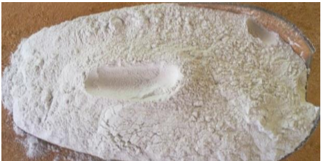
Illustration 9: Argile quartée et tamisée et Carbure de calcium résiduel séché, broyé et tamisé
