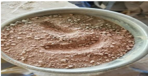
Illustration 9: Argile quartée et tamisée et Carbure de calcium résiduel séché, broyé et tamisé
