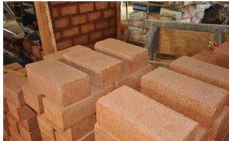
Figure 1-7: Blocs de Terre comprimée
