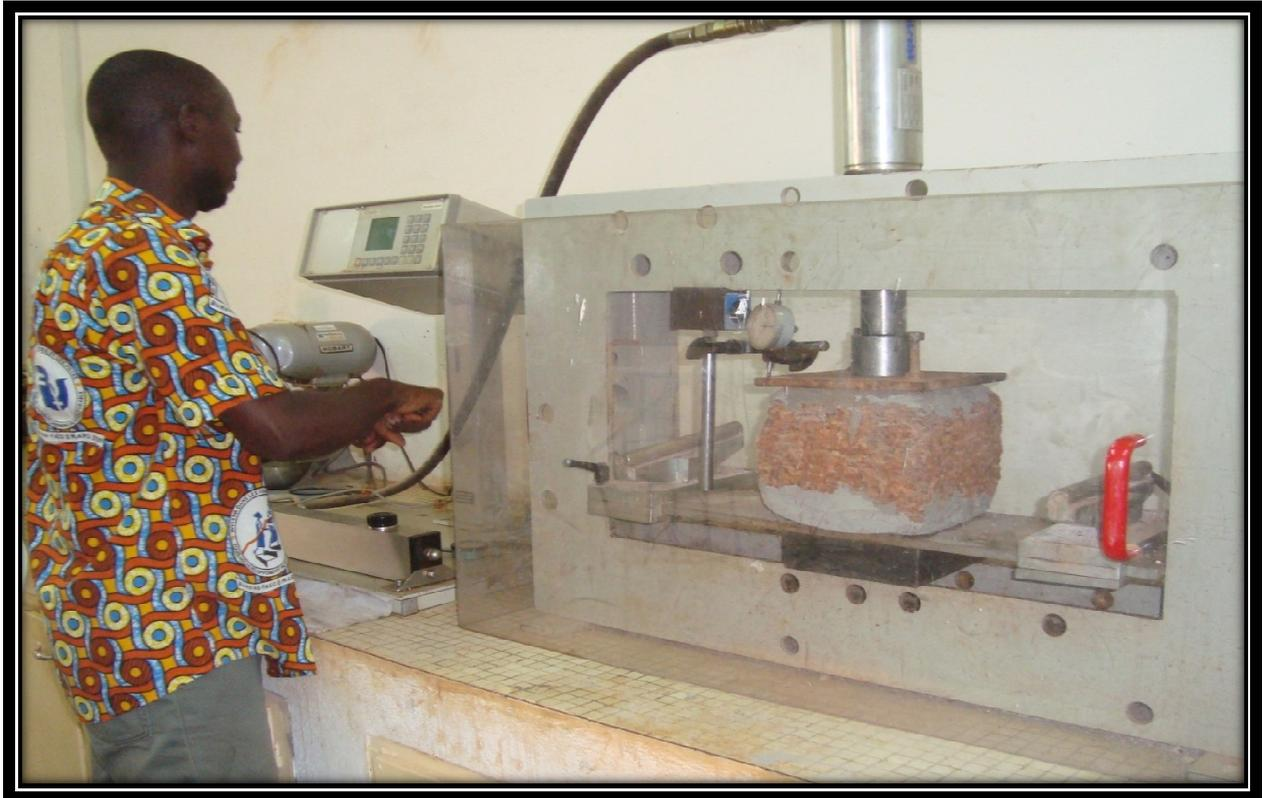
**Figure 9: Test de la résistance à la compression**
