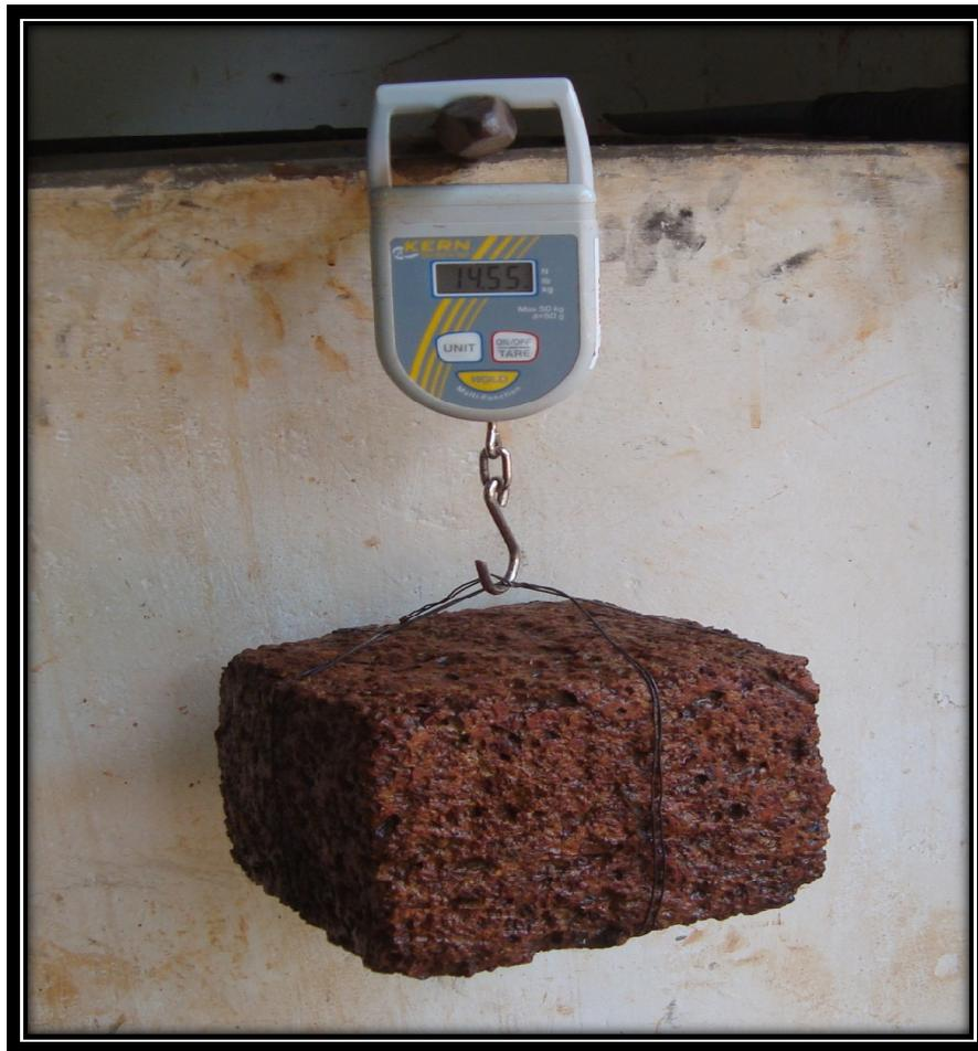
Figure 6 : peson digital (essai d'absorption)
