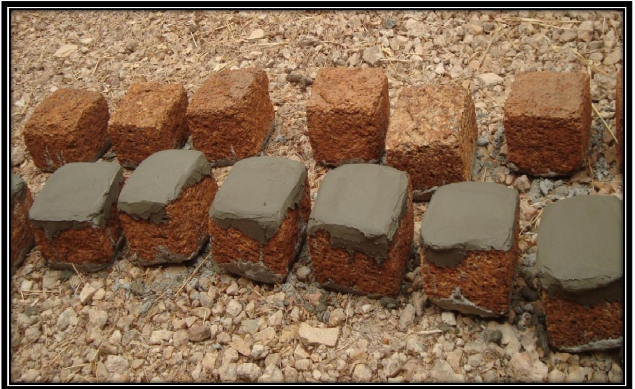
Figure 8 : Les Blocs Latéritiques Taillées enduit de mortier
