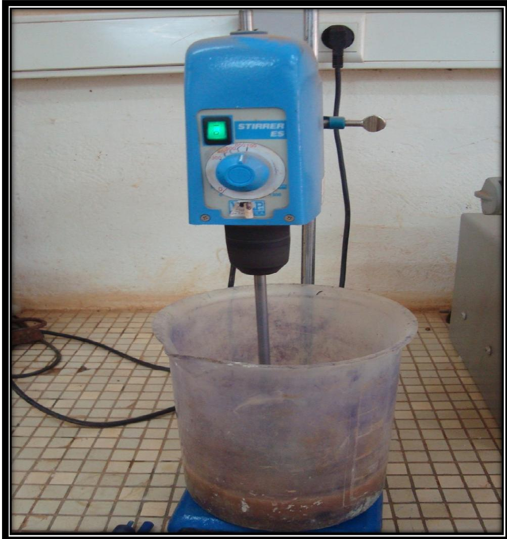
**Figure 7 : Agitateur +bêcher (essai de bleu de méthylène)**
