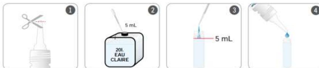
**Figure 8 : Mesure du chlore libre résiduel dans l'eau traitée (Source : Antenna Technologie)**
