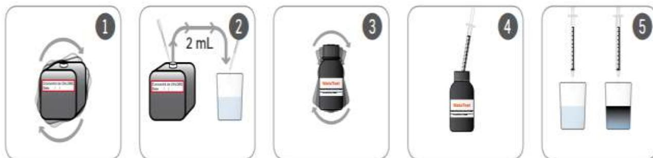
**Figure 7 : Mesure de la concentration en chlore actif dans l'hypochlorite de sodium (Source : Antenna Technologie, 2016)**
